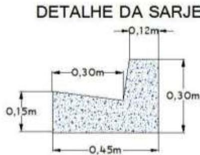
A sarjeta por sua vez deverá ser executada em concreto usinado, moldada in loco conforme especificado em projeto (detalhe acima) seguindo todas as normas técnicas vigentes.
