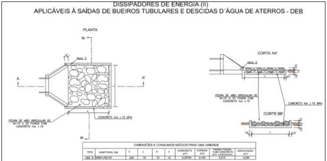
Figura 5: Dissipador de energia - DEB 01 - areia e pedra de mão comerciais
